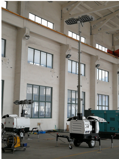
移动照明投射型灯塔
